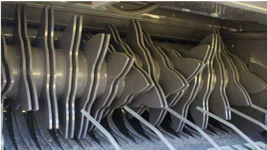
Die umfangreiche Reihe der modernsten Schneidwerke beginnt mit dem Topcut. Ein gleichmässiger Schnitt des Ernteguts wird durch 15 Schneidmesser erreicht, die tief in die Zinken des Rotors hineinreichen. Das Pressgut kann auf eine Mindestlänge von 70 mm geschnitten werden. Der Drei-Stern-Rotor garantiert einen beeindruckenden Durchsatz und eine optimale Leistung, selbst bei schwerstem Erntegut.
