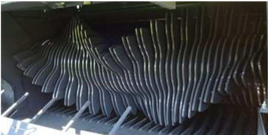
Das Ultracut 25-Schneidsystem mit wählbaren Messerblöcken wurde speziell für dieses Modell entwickelt. Durch die grosse Anzahl der Zinken hat der Ultracut-Rotor einen enormen Griff auf das Erntegut und gewährleistet die Herstellung von Silage über das ganze Jahr. Dieser hochwertige Rotor garantiert ununterbrochene Leistung und ausgezeichnete Schnittqualität bei allen Futterarten und Wetterbedingungen.
