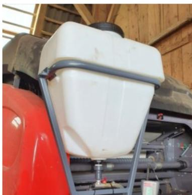
Diese Sprayeranlagen Basic hoch Comfort bestehen aus einem propionsäurebeständigen Kunststofftank. Flüssigkeitsentnahme unten mit Dreiweghahn mit Anschluss für Behälterentleerung. Ausbringung / Dosierung bis 8,3 l/min Flüssigkeit. Einstellbar, stufenlos über Drehzahlsteller. Mengenkontrolle über Manometer oder Digital ablesbar. Halterungsrahmen in verzinkter Ausführung. Leicht an jeder beliebigen Maschine zu montieren
