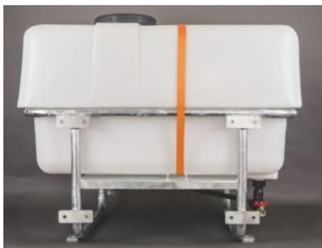
Diese Sprayeranlagen Basic 200 l bestehen aus einem propionsäurebeständigen Kunststofftank. Flüssigkeitsentnahme unten mit Dreiweghahn mit Anschluss für Behälterentleerung. Ausbringung / Dosierung bis 8,3 l/min Flüssigkeit. Einstellbar, stufenlos über Drehzahlsteller. Mengenkontrolle über Manometer oder Digital ablesbar. Halterungsrahmen in verzinkter Ausführung. Leicht an jeder beliebigen Maschine zu montieren. Spritzbalken mit zwei Düsen.
